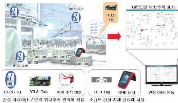
〈그림 2〉 건설현장용 RTLS 시스템 개념도, 자료 : LS산전
